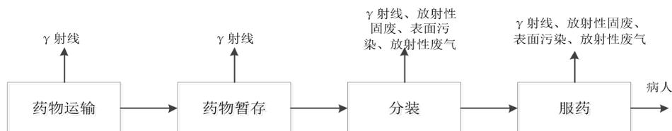
图 2-6 药物使用流程图及产污环节图
